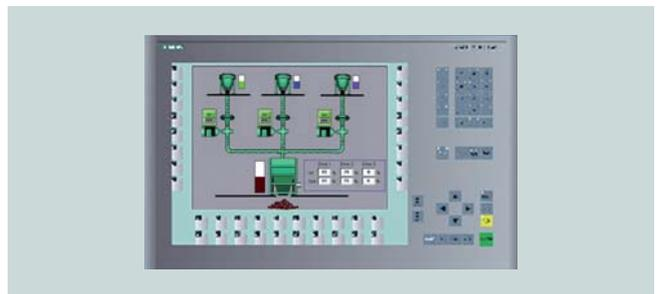
嵌入式自动化是专为嵌入式操作系统定制的控制解决方案，作为一种硬件，它需要使用坚固的无风扇、无硬盘设备。SIMATIC 多功能面板以一种特殊的方式支持嵌入式自动化。创新型硬件平台甚至为支持最复杂的 HMI 应用提供了一系列的功能和特性。例如，集成的 Microsoft Media Player 允许播放视频。Internet Explorer 和 Microsoft Viewer 允许显示多种文档，这些文档存储在本地或可通过 Internet 下载。
