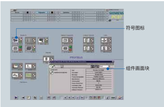
图：由符号图标构成的 PROFIBUS 区段上的组件概览
