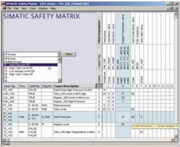
图：安全矩阵：将精确定义的反应（结果）分配给发生的事件（原因）
