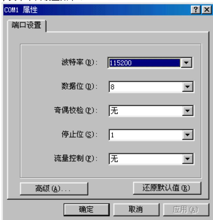
或者可使用其他的串口调试软件，如 SSCOM 等，串口设置为波特率 115200，8 个数据位，1 个停止位，无校验，无流控制。
