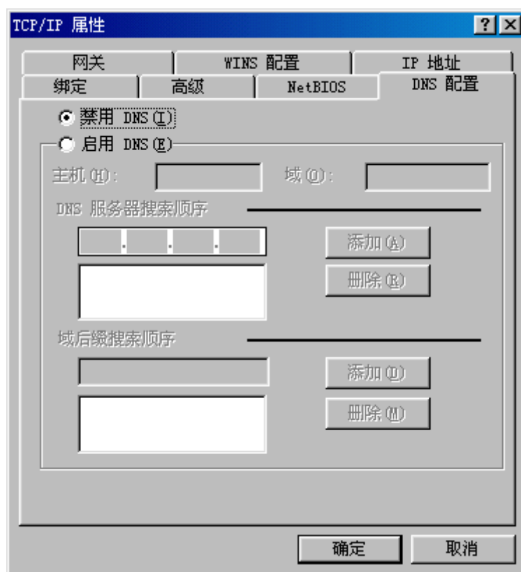
图 A-7 TCP/IP 属性 DNS 配置窗口
