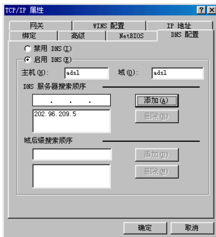
图 A-4 TCP/IP 属性 DNS 配置窗口
