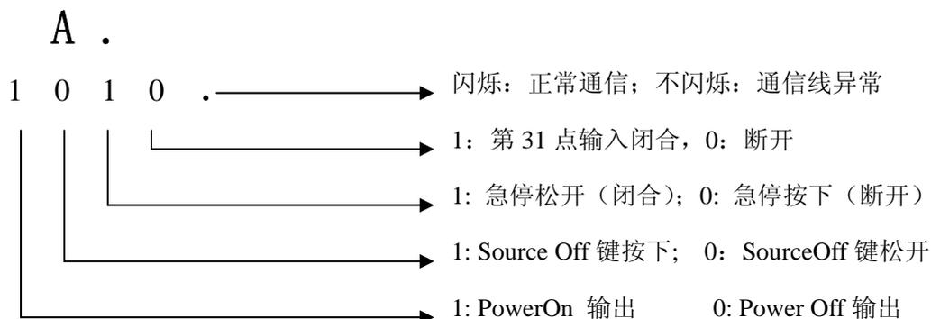
以上图 A 为例，说明此时 YIO 的状态为：第 31 点输入断开，急停松开；SourceOff 键松开，PowerON 为输出状态。
