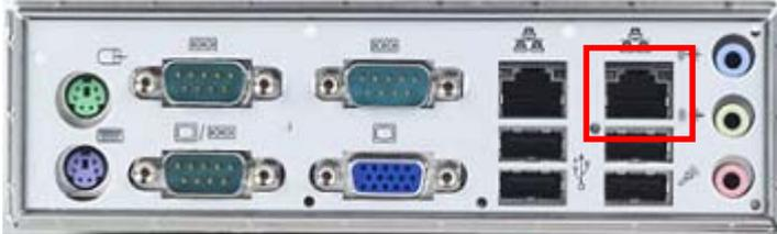
主机上共有两个 RJ45 接口，EtherCAT 用于与控制连接，接口位于主机的边上，见上图中的红色框内。
