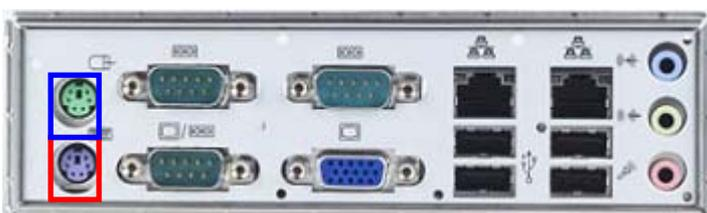
主机上共有两个 PS/2 接口，一个为键盘连接的 PS/2 接口，用于连接面板上的键盘，与 YCP 上的紫色 PS/2 相连接，见上图中的红色框内，接口颜色为紫色。另一个为鼠标连接的 PS/2 接口，如果你选配了鼠标，可将鼠标连接到此连接器，见上图中的蓝色框内，接口颜色为绿色。
