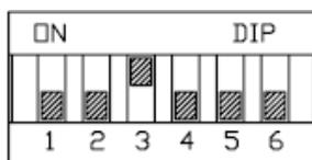
YIO 板卡的拨码开关用于设定板卡的地址编号和限位极性（常开或常闭）。NC 装置最多可以扩展 3 块 IO 卡和一块面板（YCP），每块 IO 卡必须设定不同的地址编号；注意，编号必须从 1 开始。限位极性用于超程掉电保护，0 表示限位开关的正常状态为常开，1 位常闭。根据设定的电气极性，YIO 上的 CPLD 芯片可以判断各轴是否撞到硬限位，只要任何一轴撞到硬限位，YIO 将断开主电源。所以，如果限位极性设置不当，可能导致无法正常闭合主电源。
