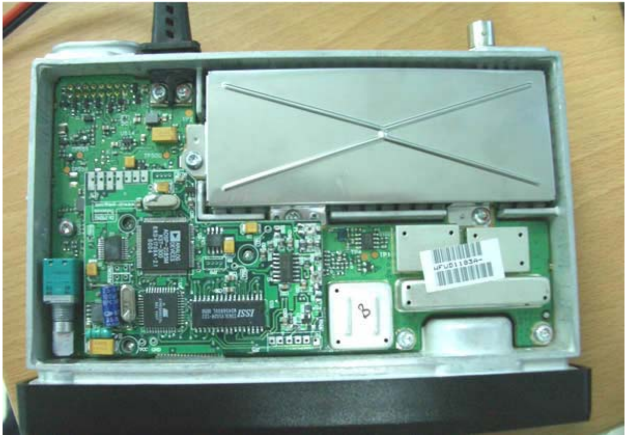
图 4 GM3188-19.2K 内置 MODEM 结构
