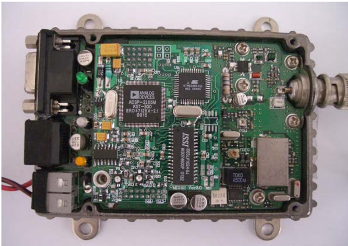
图 4 ND250A-19.2K 内置 MODEM 结构
