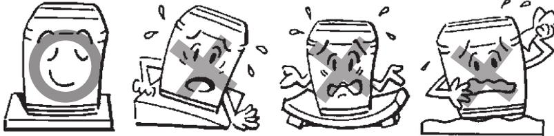
堅固水平的地面    傾斜的地面    鬆軟的地面    凹凸不平的地面
