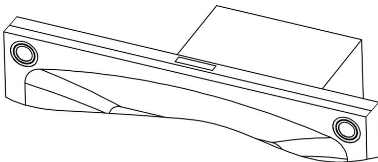
本吸油烟机采用LED照明,若照明灯损坏,请到本公司指定的维修点购买,由专业维修人员安装更换。
