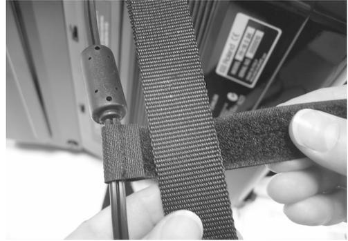
La banda se sujeta con un Velcro que la mantiene en su sitio.
