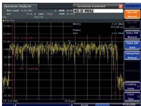
使用时域功率函数，测量宽带 WLAN 信号功率
