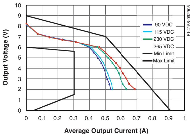
图2. 负载及输入电压变化时的输出VI特性曲线
