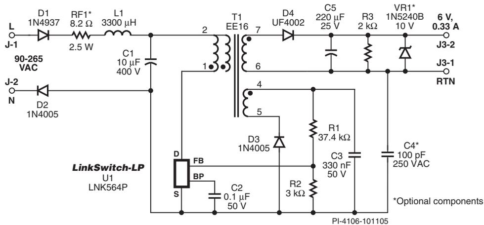
图1 使用LNK564的输出6 V、330 mA的2 W低成本反激式充电器电源
