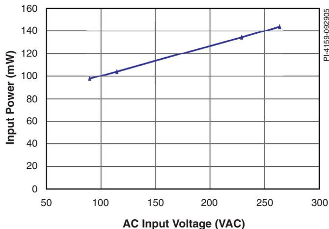
图3. 输入电压变化时的空载输入功率
