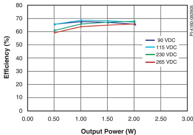
图4. 输出功率及输入电压变化时的效率
