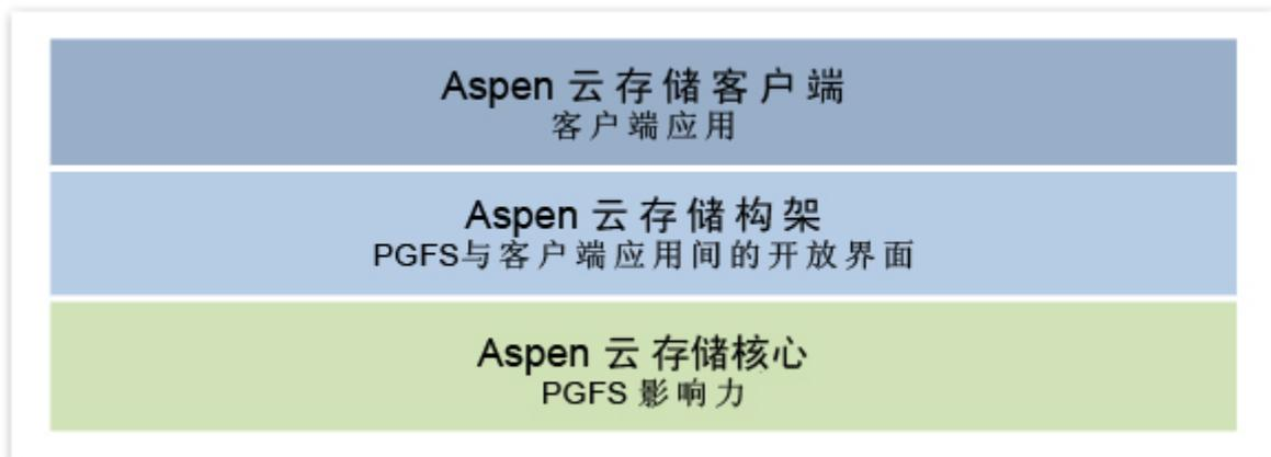
6. 上侧图是 Aspen Cloud Storage 架构。开发人员无需了解底层内容，如 Aspen Cloud Storage 核心。开发人员位于整个架构的最顶层，如 Aspen Cloud Storage 客户端。开发人员自行编写程序以调用 Aspen Cloud Storage 架构。Aspen Cloud Storage 架构的程序与平台相对独立，所以开发人员可使用任何编码调用该架构，如 JAVA, php, perl,.net and also Python. 也可以是网页或应用程序。
