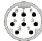
与施耐德 NEZA/TWIDO PLC 使用 MODBUS RTU 协议通讯连接
