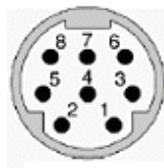
AB PLC的8针圆形阴座管脚图顶视图
