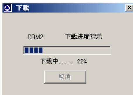
工程文件下载完毕后，关掉文本显示器电源，拔掉下载电缆线，用文本和串口设备的通讯电缆把文本显示器和串口设备连接起来。给串口设备和文本显示器上电，如果 串口通讯正常，文本显示器的Txd 指示灯会快速闪动，这时就可以进行数据监视等各项操作。 如果因为通讯参数不正确或电缆连接错误造成通讯失败，文本显示器将会显示通讯失败提示 文字“ **COM ERR!** ”，表明POP文本显示器和所连串口设备之间通讯异常。
