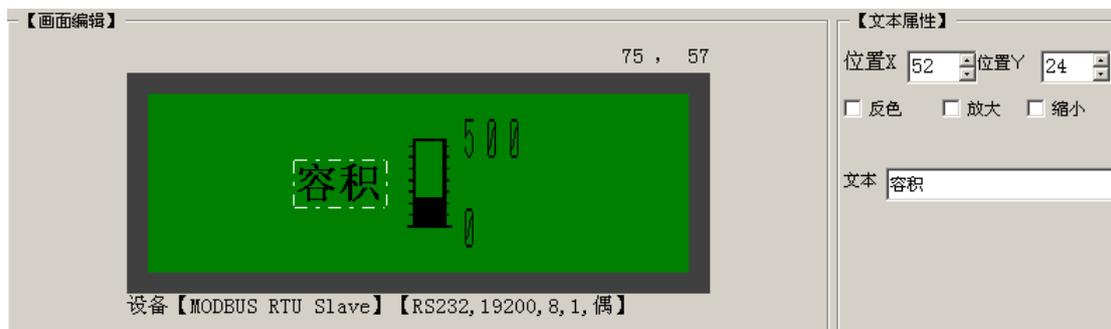
该棒状图监视所连串口设备寄存器 4X.1 中的数据，当棒状图满刻度显示时，表示寄存器4X.1 中的数据为500；当棒形图20%刻度显示时，表示寄存器4X.1中的数据为100。
