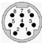
三菱PLC的8针圆形阴座管脚图顶视图
