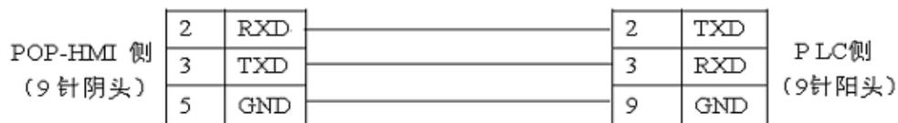
**OMRON**的**CP/CJ/CS**系列**PLC(Host Link Protocol FINS)**与早期的**CQM/CPM**系列通讯协议有所不同, 文本显示器的通讯参数设置如下:
