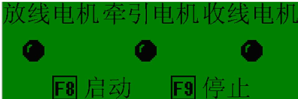
POP 文本显示器显示了设备状态监控画面，其中功能键 F8 为设备“启动”按钮，F9 为设备“停止”按钮；收线、牵引、放线电机的工作状态也呈现在状态监控画面上，操作人员可以通过此画面来控制 and 监视设备的运行情况。
