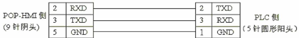
松下 PLC 的 5 针圆形阴座管脚图
