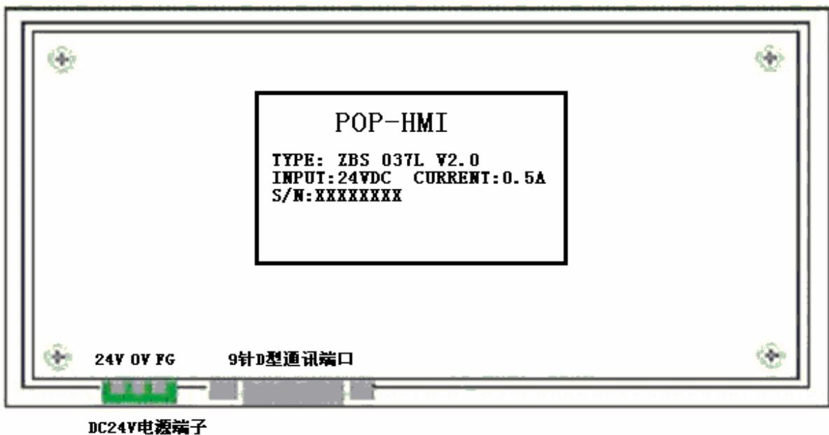
下载用户工程文件数据时，使用随产品提供的 **RS232** 通讯电缆(JB-CAB-PC)，将 POP 文本显示器的 **RS232** 通讯端口和个人计算机的串行通讯端口连接起来。POP 文本显示器和用户串口设备通讯时，必须根据所连接串口设备的类型来选择不同的通讯电缆线。
