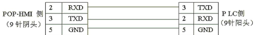
与LG PLC通讯口的连接 (Cnet协议)
