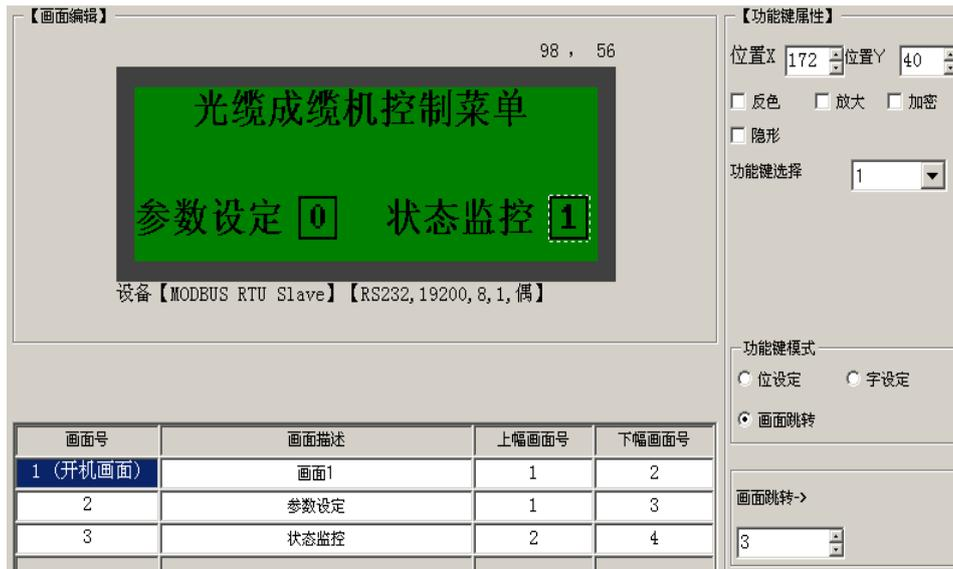
三号画面是机器设备工作状态的监控画面，正常运行时，通过文本显示器面板按键，可直接控制机器设备的启动、停止，同时状态指示灯显示机器各主要部分电机的运转状态。所连串口设备寄存器与状态指示及功能键的对应关系如下：
