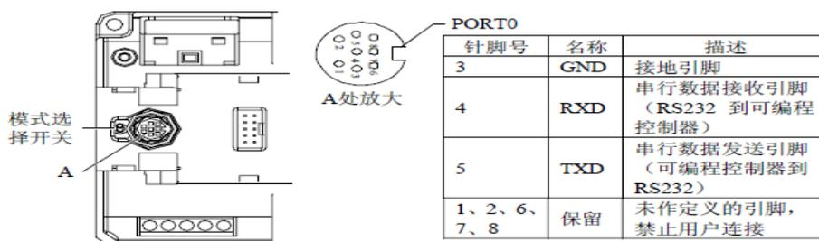
如果POP文本显示器连接EC20 PLC的通讯口0，需制作9针D型阴头和8针阳头的通讯电缆，**注意：8针阳头的管脚顺序和PLC的Port0插座定义相反。**
