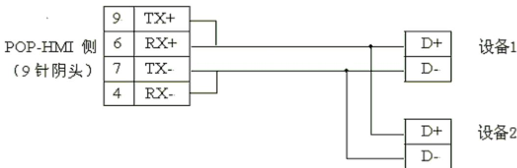
此连线图中串口设备通过 RS485 通讯口与 POP 文本显示器的 RS485 端口直连。也可通过 PLC 或串口设备的 RS232 通信端口加 232/485 转换器，再与 POP 文本显示器相连的连接方式。具体连线方法请参考所连设备厂商提供的技术手册，以避免接线错误导致通信异常。
