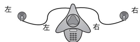
下圖顯示 SoundStation VTX 1000 會議電話在不同室內配置時的安置方式。
