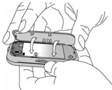
**在安装电池时，请勿损毁手机上 SIM 卡插槽上部的金属连接引脚。**
