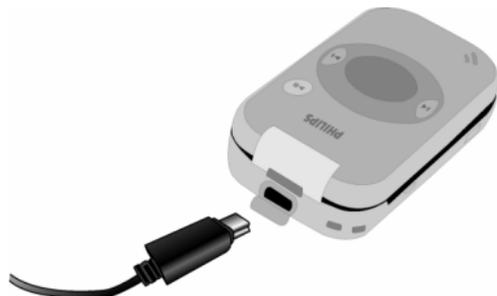
电池图标显示充电状态。在充电的时候，充电指示器将不断滚动；一般情况下，手机完全充电需要 2.5 个小时左右。当充电指示器稳定时，表示电池充满了，您可以将充电器断开。视网络和使用情况而定，充足电量后最长通话时间可达 4 小时\*，而最长待机时间可达 300 小时\*。
