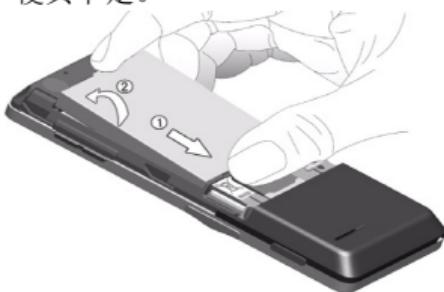
5. 如图示，将后盖对准槽口插入，前推，使其卡定。
