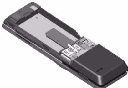
4. 如图示，将电池上的金属触点与电池槽的金属触点对齐。然后将电池装入电池槽，使其卡定。
