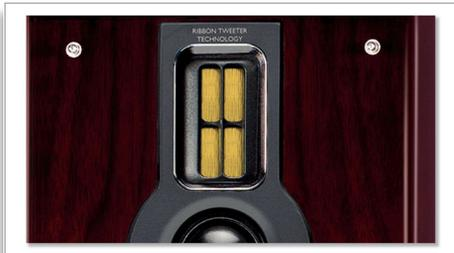
磁石鋁帶式 (Neodymium) 高音喇叭是一種單極單體可以呈現清脆生動的音質，常用於高級音響系統，可重生高傳真音質。傳統錐形或球頂形單體應用了指向性線圈移動原則，單極磁石鋁帶式高音喇叭則達 180 度廣角振幅射出高頻音。如此高頻音域更寬廣，也擴展最佳聆聽區域，即便是迷你型音響系統也能有寬廣、清晰、自然的音質。
