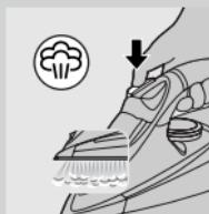
**1** 要想在熨烫过程中使用加强蒸汽，请按住蒸汽蒸汽束喷射按钮。
