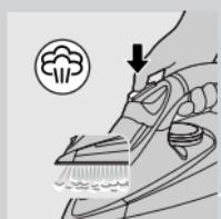
特制的底板前端尖型设计，会喷出蒸汽束，帮助去除顽固的皱褶。喷射的蒸汽束能将蒸汽渗透到衣物的任何细微之处。
