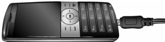
电池图标表示充电状态。在充电过程中，充电指示条会滚动。手机完全充电大约需要 3 小时。当所有滚动条稳定时，电池即被完全充满。这时可以断开充电器。
