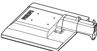
2. 請用雙手抓住顯示器底座支架，並將底座支架確實裝入底座安裝座中。
