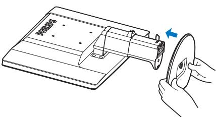
3. 將顯示器的底座支架裝入安裝座中，然後將底座支架固定。
