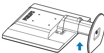
3. 解開底座支架的鎖，然後從底座安裝座卸下底座支架。
