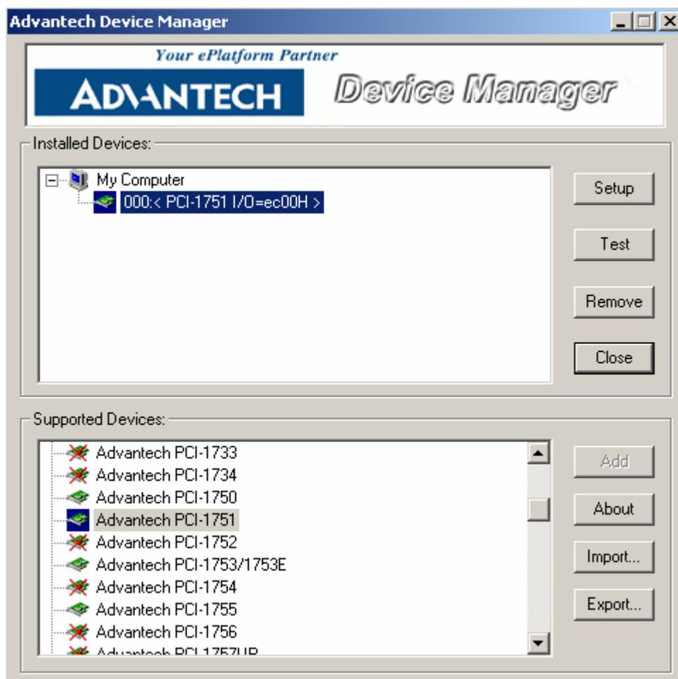
当您的计算机上已经安装好某个产品的驱动程序后，它前面将没有红色叉号，说明驱动程序已经安装成功。比如上图中的 PCI-1751 前面就没有红色叉号。PCI 总线的板卡插好后计算机操作系统会自动识别，Device Manager 在 Installed Devices 栏中 My Computer 下也会自动显示出所插入的器件，这一点和 ISA 总
