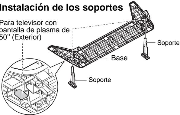
Inserte los soportes en los agujeros izquierdo y derecho de la parte inferior de la base para que se ajusten firmemente como se muestra en la ilustración.
