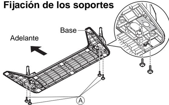
Utilice los tornillos de montaje (A) para asegurar firmemente los soportes en la parte inferior de la base.
