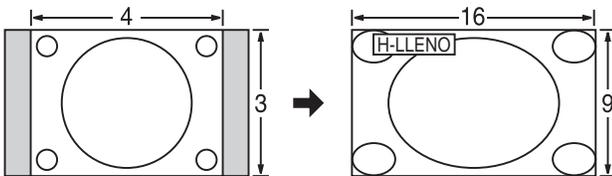
Amplía horizontalmente la imagen 4:3 hasta los bordes laterales de la pantalla. Los bordes laterales de la imagen se recortan.
