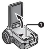
Abra el monitor LCD y luego deslice la palanca de apertura de la ranura de la tarjeta ① para abrir la tapa de la ranura de la tarjeta.
