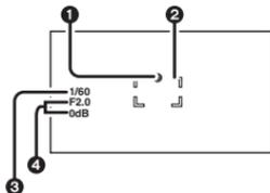
La velocidad del obturador y el valor de iris/ganancia son fijos y la unidad enfoca al sujeto automáticamente.
