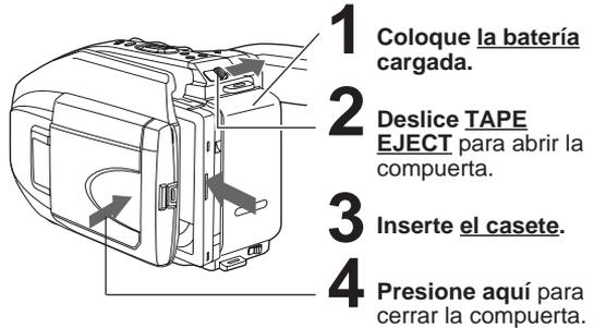
**1** Coloque la batería cargada.
