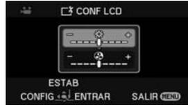
**2** Desplace el joystick hacia arriba o hacia abajo a fin de seleccionar el detalle a ser ajustado.
