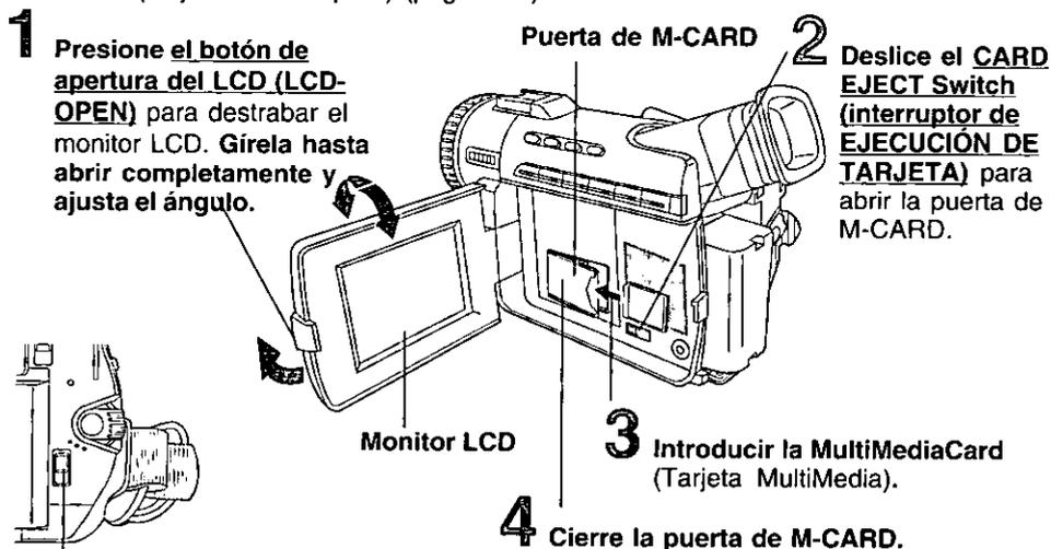
Al utilizar una MultiMediaCard (Tarjeta MultiMedia), debe usted ajustar el TAPE/M-CARD Switch (interruptor TAPE/M-CARD) a M-CARD.
