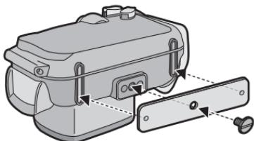
Si utiliza 1 peso, alinee la parte saliente del peso con el receptáculo del trípode en el estuche marino y, luego usando un destornillador ranurado o algo por ese estilo, utilice el tornillo de unión de los pesos suministrados para unir al receptáculo del trípode.
