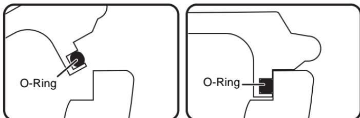
Wird der O-Ring durch den Wasserdruck zusammengedrückt, dehnt sich dessen Oberfläche aus und das Gehäuse wird so noch besser abgedichtet.
