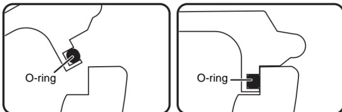
Quando l'O-ring viene schiacciato dalla pressione dell'acqua, la superficie dell'O-ring si espande, sigillando più saldamente la custodia.
