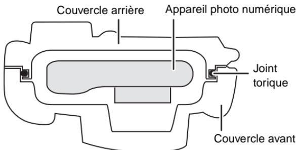
Le caoutchouc entre en contact avec les côtés du boîtier, le rendant ainsi étanche et empêchant l'eau d'entrer par l'ouverture.
