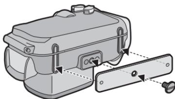
如果使用 1 个加重块，请将加重块的突出部分对准潜水盒上的三脚架插座，然后使用一字螺丝刀或类似的工具用提供的加重块安装螺丝将加重块安装到三脚架插座上。
