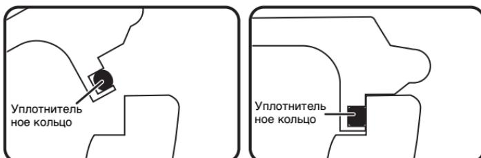
При сдавливании уплотнительного кольца давлением воды поверхность кольца расширяется, за счет чего обеспечивается более плотная герметизация футляра.
