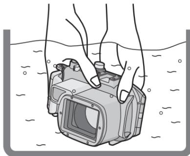
☞ Effectuez le même test après avoir mis en place l'appareil photo numérique dans le boîtier. (P37)
