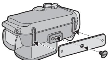
Lors de l'utilisation d'un poids, alignez la partie en saillie du poids avec le réceptacle du trépied sur le boîtier marin, puis avec un tournevis pour écrous à fente ou semblable, utilisez la vis fournie avec le poids pour le fixer au réceptacle du trépied. Si vous utilisez les deux poids, alignez la partie en saillie du deuxième poids avec la partie en creux du premier poids afin qu'ils ne soient pas superposés puis fixez-les au réceptacle du trépied.
