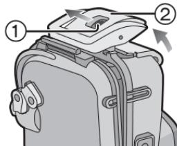
**2 Installez l'appareil photo numérique dans le boîtier.**
