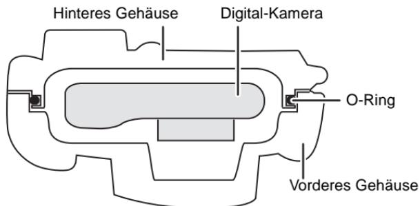
Das Gummi befindet sich in Kontakt mit den Gehäuseseiten, macht das Gehäuse so wasserdicht und verhindert, dass über den Zwischenraum Wasser eintritt.
