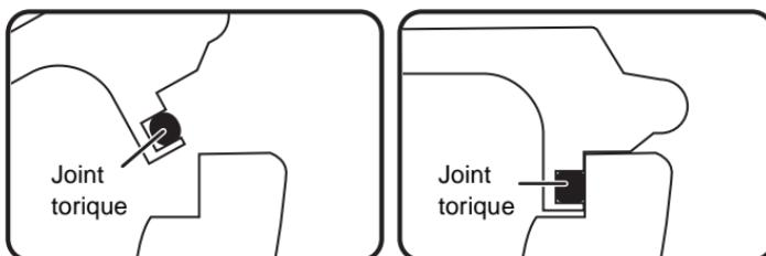
Quand le joint torique est écrasé par la pression de l'eau, sa surface s'élargit et le boîtier est scellé plus hermétiquement.
