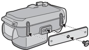
如果使用 1 個加重塊，請將加重塊的突出部分對準潛水盒上的三腳架插座，然後使用一字螺絲刀或類似的工具用提供的加重塊安裝螺絲將加重塊安裝到三腳架插座上。
