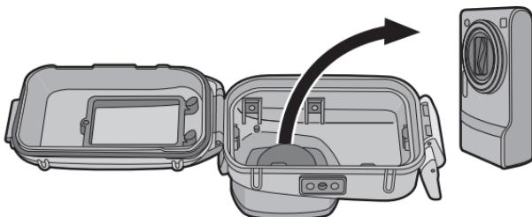
**4** Den O-Ring aus dem Gehäuse entfernen und sicherstellen, dass keine Rückstände, o.ä. in der Nut des O-Rings vorhanden sind.
