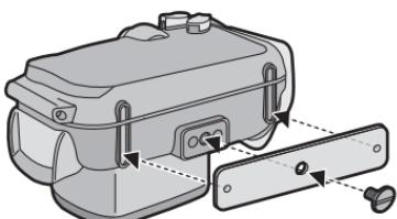
Wenn Sie 1 Gewicht verwenden, richten Sie den vorstehenden Teil des Gewichts wie abgebildet am Stativanschluss des Unterwassergehäuses aus, setzen Sie die mitgelieferte Befestigungsschraube ein und schrauben Sie das Gewicht mit einem Schlitzschraubendreher am Stativanschluss fest.
