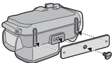
Se si utilizza 1 peso, allineare la parte sporgente del peso con l'attacco del treppiede sulla custodia marina, quindi utilizzando un cacciavite a taglio o uno strumento analogo installare il peso sull'attacco con l'apposita vite. Se si utilizzano 2 pesi, allineare la parte sporgente del secondo peso con la parte incavata del primo, in modo che i pesi non si sovrappongano, quindi installarli sull'attacco per il treppiede.
