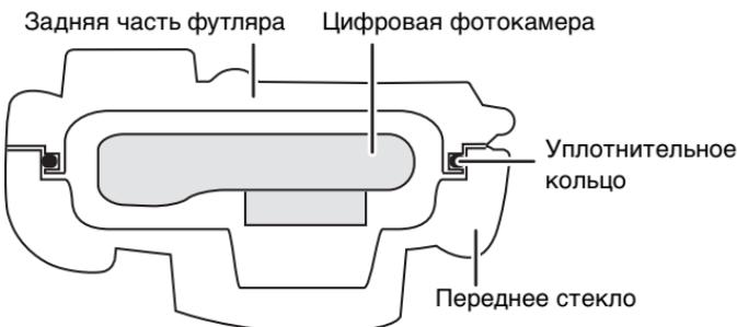
Резина кольца входит в контакт с торцами частей футляра, тем самым обеспечивая водонепроницаемость и не допуская пропускания воды через стык.
