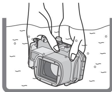
■ 在将数码相机装入盒子后, 请进行同样的测试。(P151)
