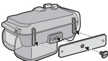
При использовании 1 груза совместите выступающую часть груза с гнездом штатива на футляре для подводной съемки, а затем с помощью крестообразной или другой отвертки установите винт для крепления грузов, входящий в комплект поставки, и прикрепите его к гнезду штатива.
