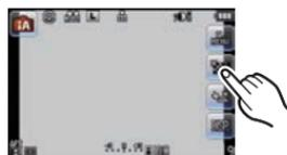
**2** Toque la barra deslizadora para fijar.
