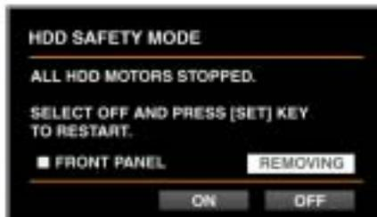
拆下正面面板的電纜線，然後開始更換內建硬碟。
