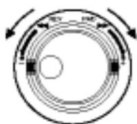
設備能夠依照往復環的旋轉程度改變播放速度(1/2x、1x、2x、5x、10x、20x)。當往復環固定在 20 倍的位置(轉到底)5 秒鐘時，播放速度會變成 50 倍。當播放速度變成 50 倍後，往復環仍然在此位置 5 秒鐘，則播放速度會變成 100 倍。
