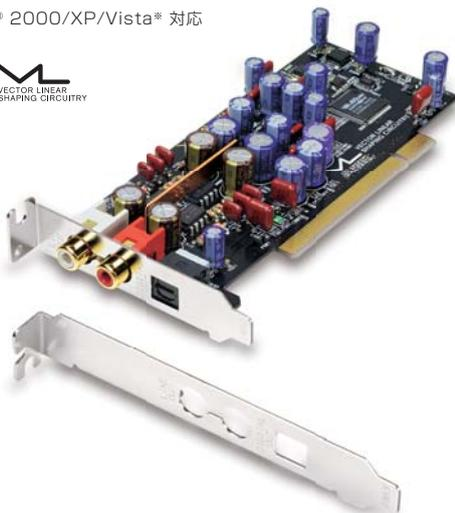
SN比110dBを実現。24bit/192kHzデジタル出力対応。再生品質に徹底的にこだわった、再生専用2ch PCIデジタルオーディオボード
