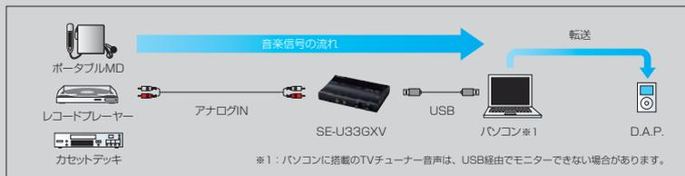
最高品質、SN比115dB。24bit/96kHzの音楽信号に対応
