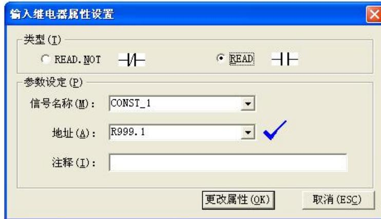
图 4.12 输入继电器属性设置对话框
