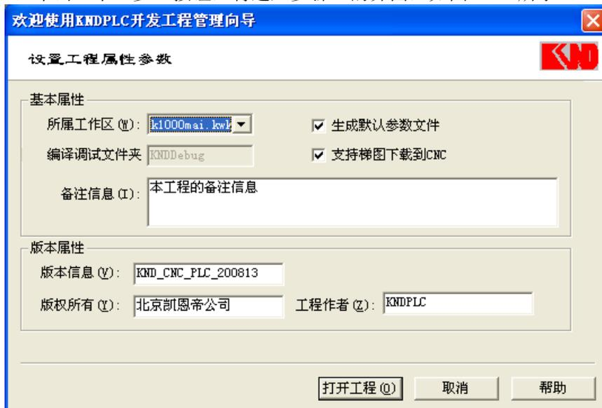
图 4.25 打开一个存在工程的工程向导步骤二界面
