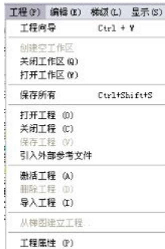
(1) “工程向导”：调用工程管理向导对话框，通过向导创建工程。可以使用 Ctrl+W 打开工程向导。
