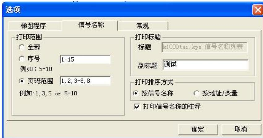
图 4.62 打印信号名称选项设置界面示例
