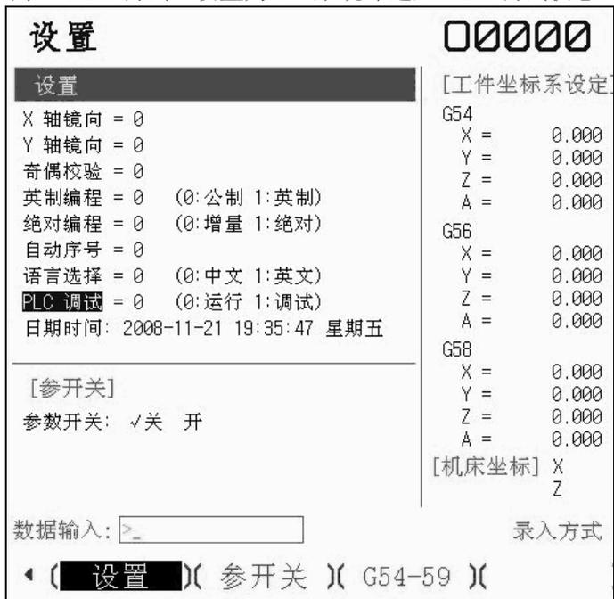
图 5.3 PLC 调试开关
