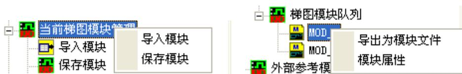
图 4.51 当前梯图模块管理相关右键菜单示例(1)、(2)
