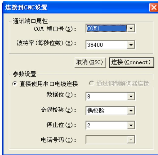
图 5.6 通讯参数设置对话框
