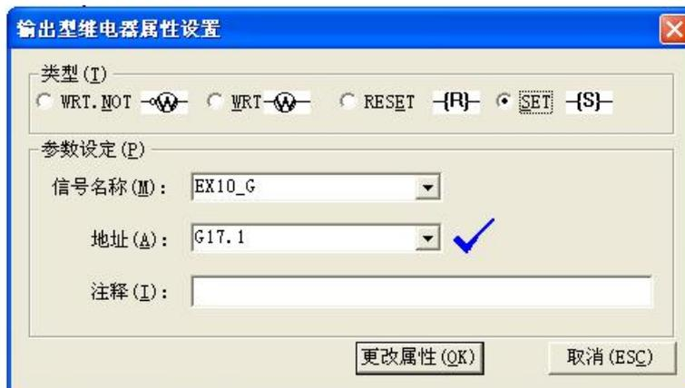
图 4.13 输出继电器属性设置对话框
