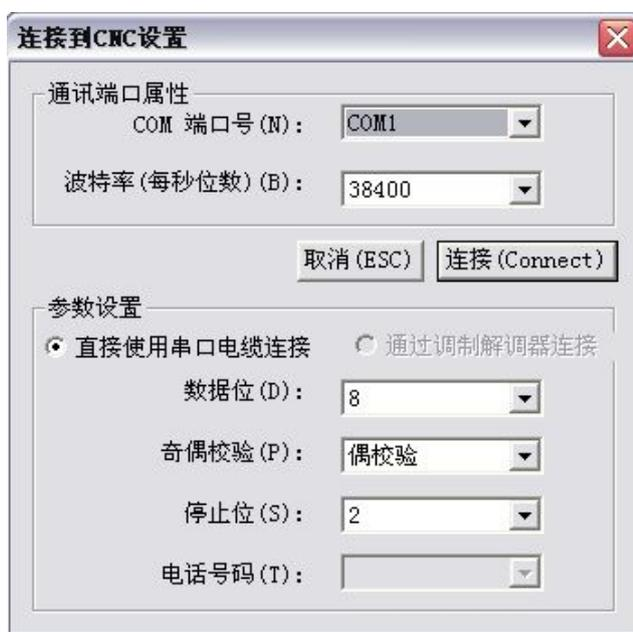
需要对该对话框中的内容进行设定，使其与 CNC 系统侧的参数设置一致。设置好相关参数，点击「确定」，放弃，点击「取消」。
