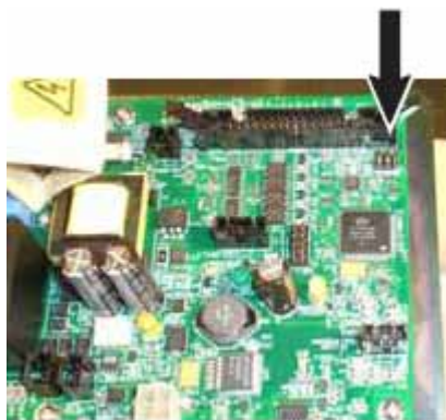
图 5-12 120 欧姆镍基胶机——没有安装跳线
