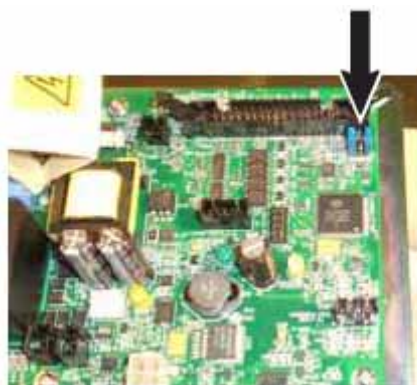
图 5-11 100 欧姆铂胶机——安装跳线
