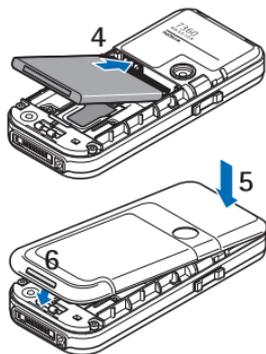
使后盖的顶部对准手机的顶部 (5)，然后按后盖的底部以使其锁定到位 (6)。
