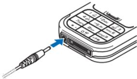
2. 将充电器的连接线插头插入手机底部的插孔中。
