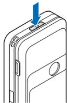
要启动手机，请按住电源键。如果手机要求输入 PIN 码或 UPIN 码，请输入所需密码(屏幕上会显示为 \*\*\*\*)，然后选择**确认**。
