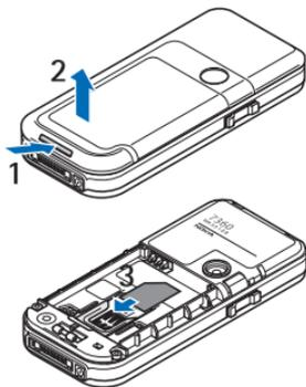
确保 SIM 卡的金色触点朝下，并将 SIM 卡插入 SIM 卡卡夹中直至锁定到位 (3)。
