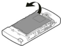
安全取出电池。取出电池前，请务必关闭设备并断开与充电器的连接。
