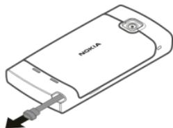
某些功能（例如手写识别）在设计时就考虑到使用触控笔。触控笔位于设备的后盖中。
