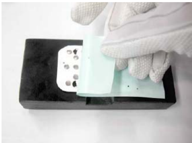
3.) 把新的键盘膜放置到键盘更换工具上，并撕走保护膜。
