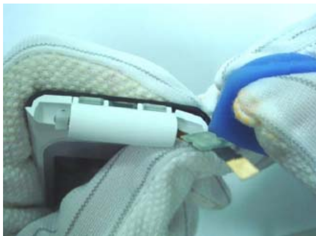
26.) 用 SRT-6 插入到螺丝盖与 A 壳的缝隙中，撬出螺丝盖。
