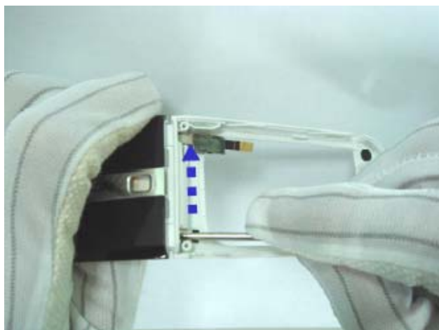
22.) 用平嘴螺丝刀从图中位置插入，并往展示方向压紧转轴。
