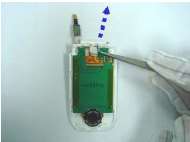
33.) 从显示屏模块中取出减震垫。
