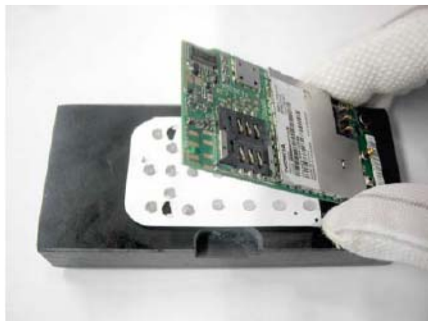
4.) 对准定位柱，把主板放到工具上。
