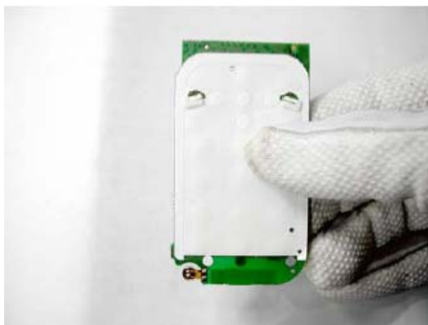
6.) 最后确保键盘膜位置正确，然后抹平它。
