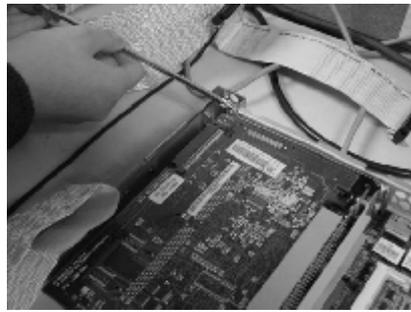
图 3-9 安装板卡挡片固定螺丝
