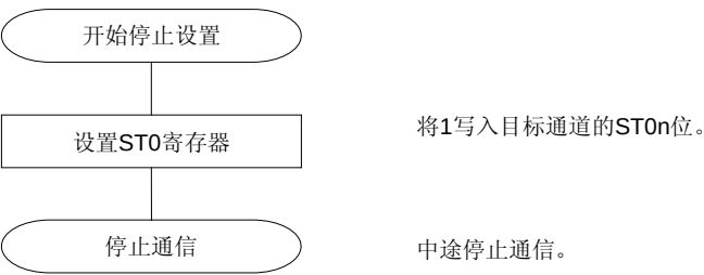
图 12-47. 停止从机发送的步骤
