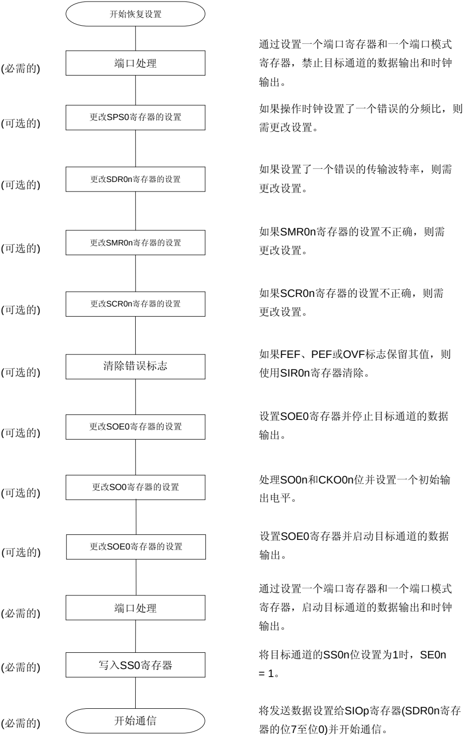
图 12-40. 恢复主机发送/接收的步骤
