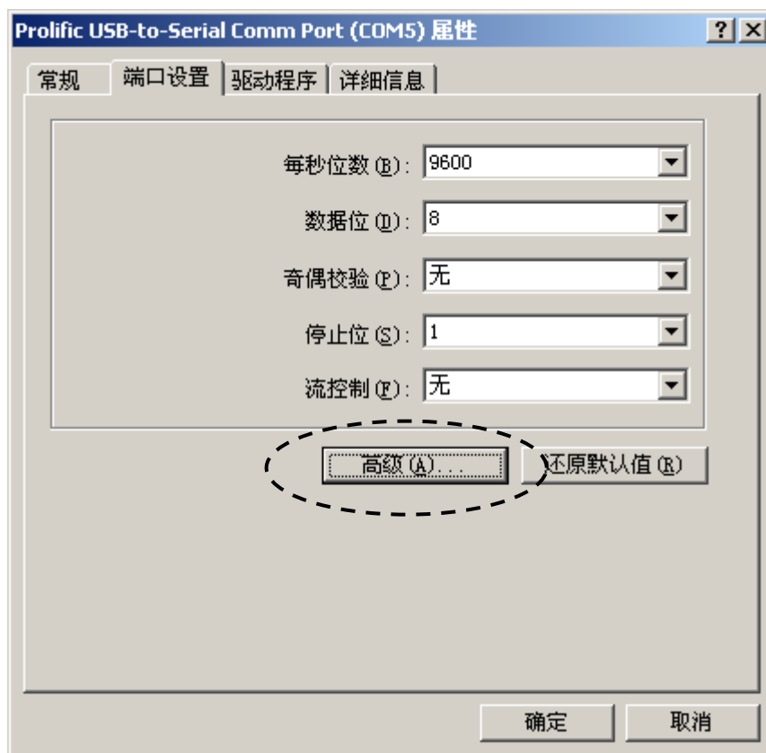
图 3-36 Profile USB-to-Serial Comm Port (COMn) 属性窗口
