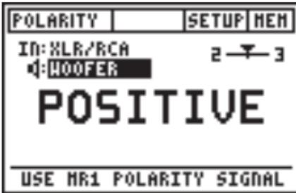
图 3.13 低音扬声器极性测试面板
