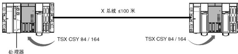
**注意：**TSX CSY 84 / 164 模块不能安装在属于远程 X 总线段（通过 TSX REY 200 模块扩展）的机架中。
