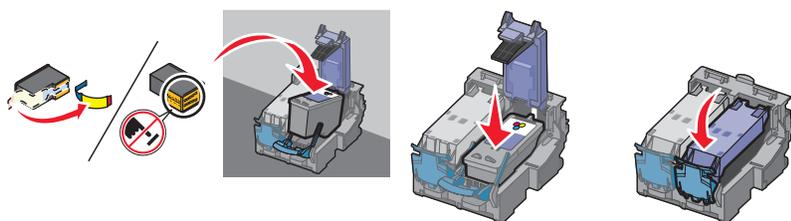
**警告—可能的损坏：** 请不要用手触摸打印墨盒后面的金色触点区域或打印墨盒底部的金属喷头区域。
