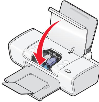
**注意：**打印机的顶盖必须完全关闭，然后才可以开始新的打印作业。
