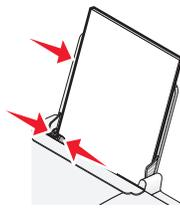
**注意：**为了避免发生卡纸，请确认调节进纸导轨时没有使纸张弯曲。
