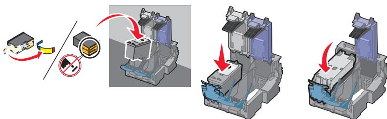
**警告—可能的损坏：** 请不要用手触摸打印墨盒后面的金色触点区域或打印墨盒底部的金属喷头区域。
