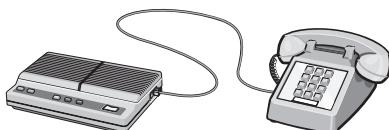
**5** 使用第三根电话线连接电话答录机和打印机后面的 EXT (电话分机) 插口
