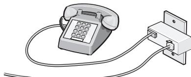
如果您的电信设备使用美式的 RJ11 电话线，请按照以下的步骤连接设备：
