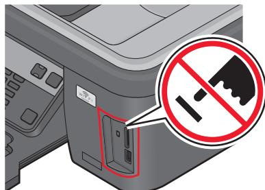
**警告—可能的损坏：**当正在从 PictBridge 兼容数码相机中打印时，请不要触摸 USB 电缆、任何网络适配器、任何接口或图中所示的打印机区域，否则可能会发生数据丢失。
