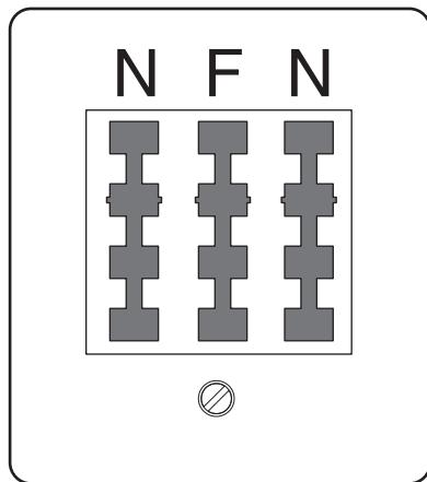
将打印机连接在任意的 N 插口上。
