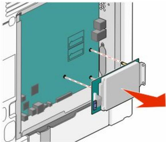
d 取下将打印机硬盘固定板安装到打印机硬盘上的翼形螺钉，然后取下固定板。将打印机硬盘放在一边。
