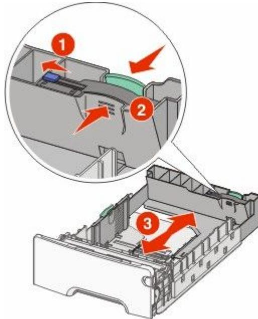
**注意：**长度导片有一个锁定装置。要解锁进纸匣，请将长度导片顶部的按钮滑到左边，如图所示。一旦长度已被选定，要锁定进纸匣，请将按钮滑回到右边。
