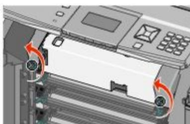
**b** 抬起熔印部件两边的把手，然后向前拉来移除熔印部件。
