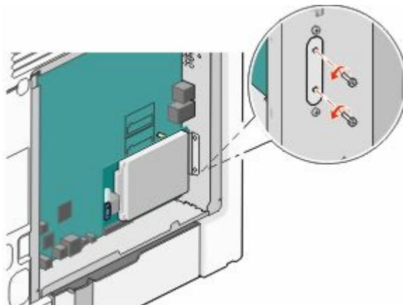
c 通过向上拉打印机硬盘使其脱离螺孔来移除它。
