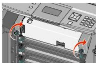
**5** 关闭顶部盖板，然后关闭前部盖门。
