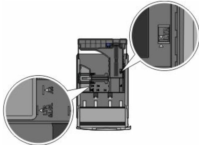
2 如图所示，压住宽度导片凸柱，然后将宽度导片滑动到与加载的纸张尺寸相符的正确位置上。
