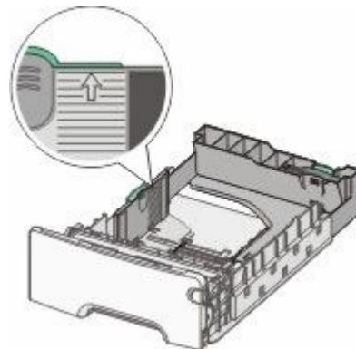
**3** 压住长度导片凸柱，然后将长度导片滑动到与加载的纸张尺寸相符的正确位置上。
