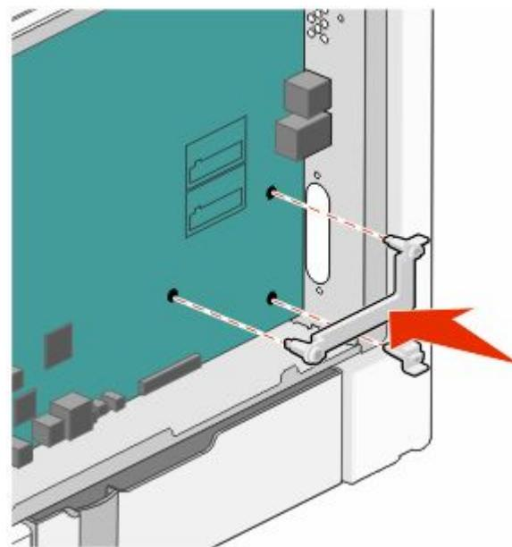
**6** 将 ISP 安装在塑料底座上。使 ISP 在塑料底座上面呈一定角度，然后靠近塑料底座，以便让任何伸出的连接器能通过系统板框架中的 ISP 开口。
