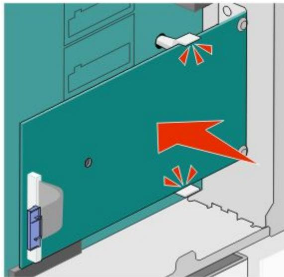
**8** 插入长的翼形螺钉并顺时针旋转使 ISP 固定到位，但是此时不要拧紧翼形螺钉。
