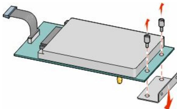
**b** 将打印机硬盘的螺孔与 ISP 上的孔对齐，然后向下压打印机硬盘直到螺孔固定到位。
