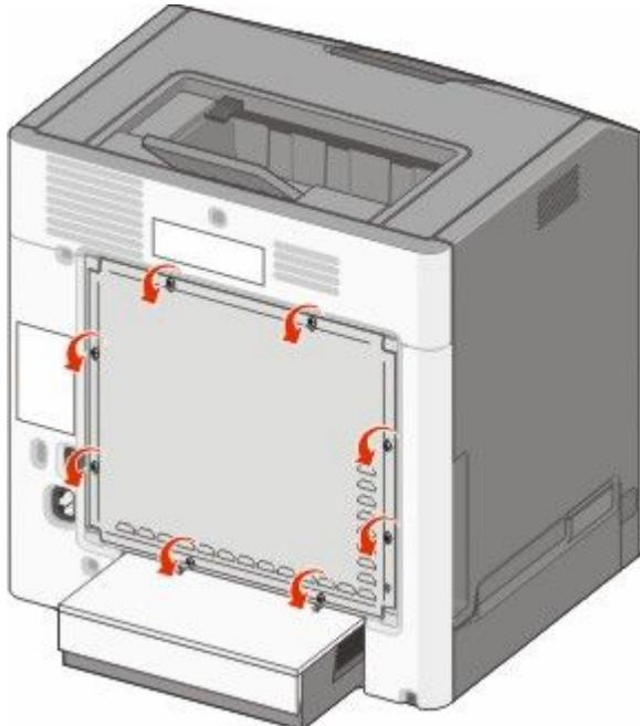
**b** 将盖板向上滑动, 直到每个螺钉都位于栓孔中。
