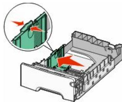
请注意位于进纸匣左边的加载线：它指示加载纸张的最大高度。
