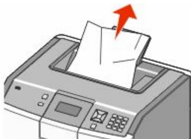
**2** 如果纸张卡在靠近熔印部件的辊下面：
