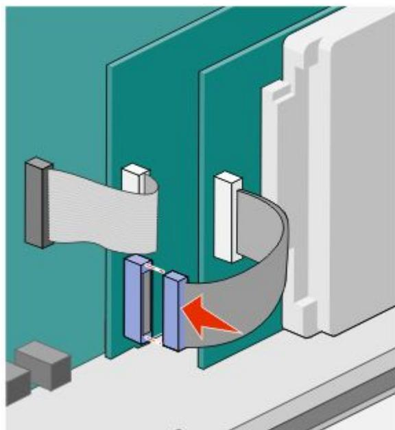
要将打印机硬盘直接安装到系统板上：
