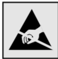
此符号表示对静电敏感的部件。请先接触打印机的金属外框，再接触这些符号附近的区域。
