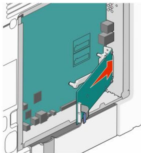
**7** 朝着塑料底座放低 ISP 直到 ISP 被固定在塑料底座的导轨之间。
