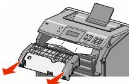
**c** 将熔印部件放在平坦的表面上。
