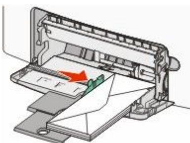
**警告—可能的损坏：**永远不要使用带有邮票、卡扣、摁扣、窗口、涂层或自动粘胶的信封。这些信封可能会严重损坏打印机。
