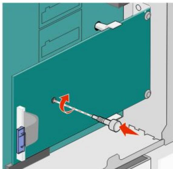
**9** 安装提供的两个螺钉来将 ISP 固定板固定在系统板框架上。
