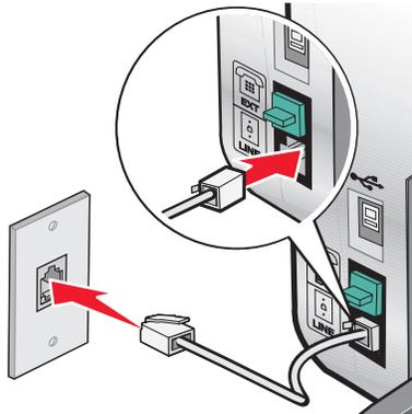
3 从打印机后面的 **EXT**（电话分机）插口
