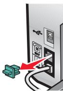
2 将您的电信设备直接连接在打印机后面的 EXT（电话分机）插口上。
