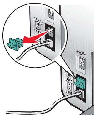
4 使用第二根电话线连接电话机和计算机调制解调器。
