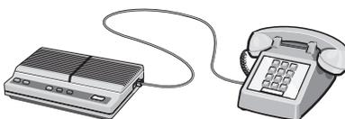
5 使用第三根电话线连接电话答录机和打印机后面的 EXT（电话分机）插口
