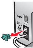
**注意：**当去掉保护塞后，您通过适配器连接在打印机上的任何国家 / 地区的设备（如图所示）都将不能正常工作。
