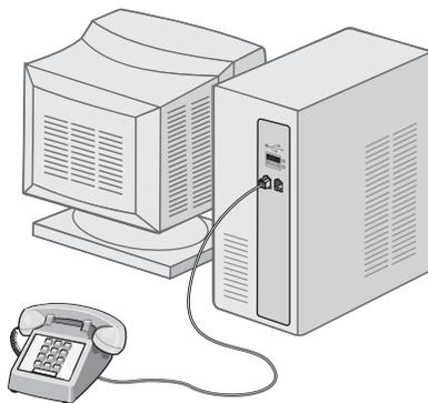
5 使用第三根电话线连接计算机调制解调器和打印机后面的 EXT（电话分机）插口
