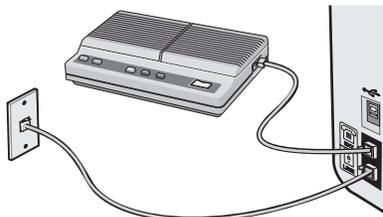
**注意：**当去掉保护塞后，您通过适配器连接在打印机上的任何国家 / 地区的设备（如图所示）都将不能正常工作。
