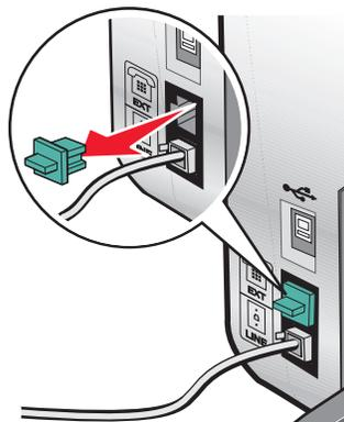
4 使用另一根电话线连接电话机和打印机后面的 EXT（电话分机）插口
