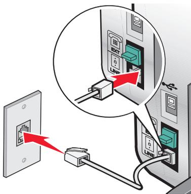
3 从打印机后面的 EXT（电话分机）插口
