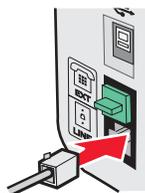
3 将电话线的另一端连接在可用的墙壁电话线插座上。
