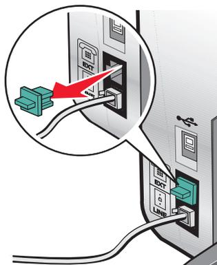
4 使用第二根电话线连接电话机和电话答录机。
