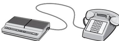
5 使用第三根电话线连接电话答录机和打印机后面的 EXT（电话分机）插口
