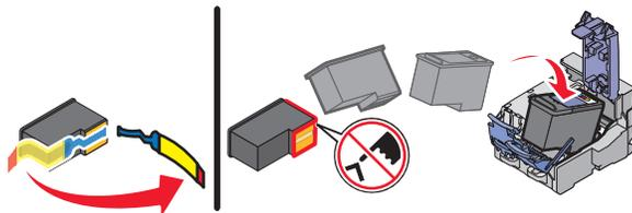
**警告—可能的损坏：** 请不要用手触摸打印墨盒后面的金色触点区域或打印墨盒底部的金属喷头区域。
