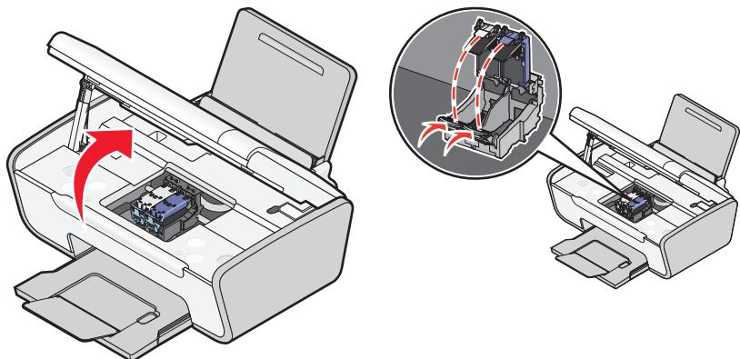
**7** 撕掉黑色打印墨盒上的透明封条，将打印墨盒装入左侧的墨盒拖车内，然后关闭黑色打印墨盒的保护盖。
