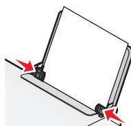
**注意:** 为了避免发生卡纸, 请确认调节进纸导轨时没有使纸张弯曲。
