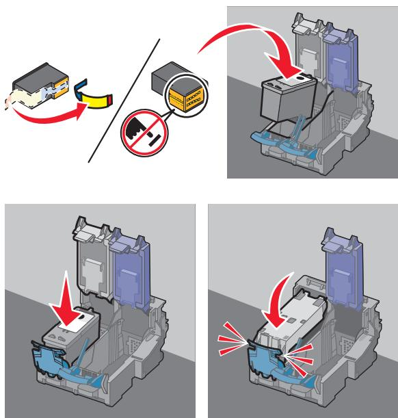
**8** 撕掉彩色打印墨盒上的透明封条，将打印墨盒装入右侧的墨盒拖车内，然后关闭彩色打印墨盒的保护盖。
