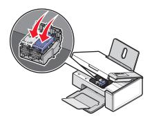
5 抬起扫描仪部分,将扫描仪支架向打印墨盒拖车的方向推,然后轻轻地放下扫描仪部分,直到完全关闭。
