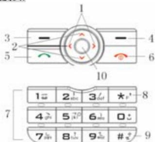
**1. 左右键：**编辑时左右滚动光标；待机状态，按**左键**进入情景模式菜单，按**右键**进入信息服务菜单；在数码相机预览状态，按**左右键**可做数码相机环境设置切换。
